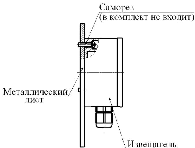
Рисунок 3.4 - Крепление извещателя на металлическом листе
