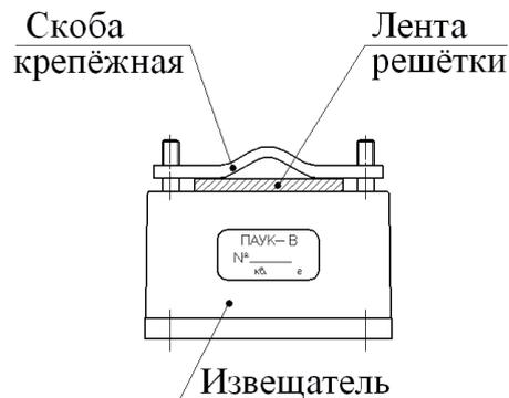
Рисунок 3.2 - Крепление извещателя на решетке из металлических лент
