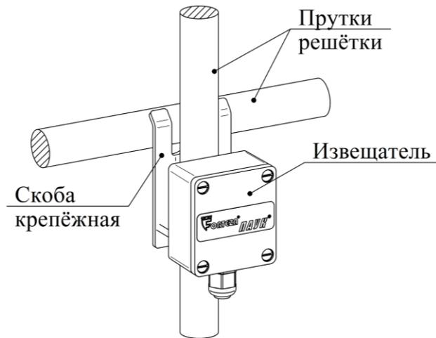
Рисунок 3.1 - Крепление извещателя на решетке из прутка
